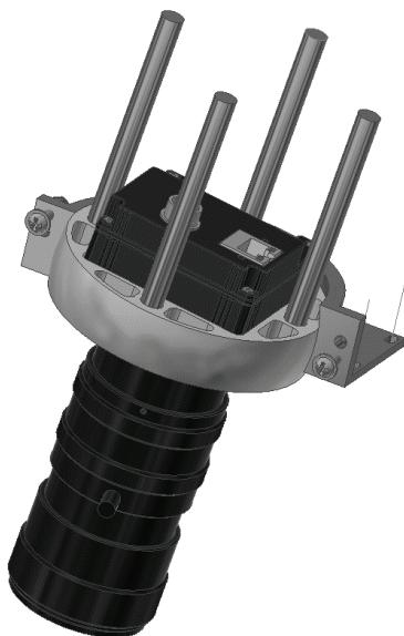
*Рис. 4. Юстировочный механизм ТВ-камеры*
